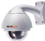
Купольная поворотная камера в **металлическом миникорпусе**, размер прозрачного купола 3.5" (9 см), в комплекте кронштейн. **Вандапоустойчивое** исполнение камеры - прозрачный купол выполнен из самого прочного пластика - **Поликарбоната**. **Уличная модификация IP66**: рабочий режим от **-50 ° С до +60 ° С**, встроенные **термоэлементы и вентиляторы**. **Скорость поворота** по горизонтали 0.1°-80°/с, по вертикали 0.1°-60°/с, по заданной позиции **100°/с**, точность 0.2°
