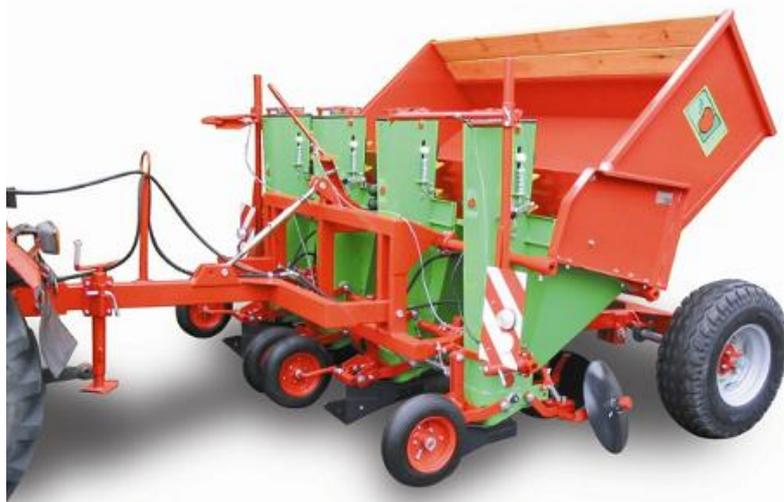
Четырёхрядная прицепная картофелесажалка KORA 4HP с гидравлически поднимаемым бункером ёмкостью 2000 (2200 кг.) предназначена для посадки не проросшего картофеля, высаживаемого в почвах влажностью до 16%, на полях с углом наклона до 7-12%. Отличительными
