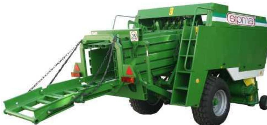
Пресс-подборщик крупногабаритный высокой степени прессования является высокопроизводительной машиной, которая служит для сбора соломы (включая рапсовую) сена зеленой массы, предназначенной на силос.
