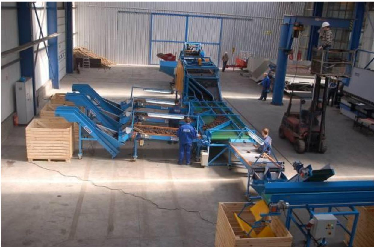
Сортировочная линия для картофеля и лука 25-30ТОН предназначена для сортировки клубней картофеля на 4 фракции : клубни мелкие – отбросы, семенные клубни I, семенные клубни II и клубни крупные. Состав оснащен сортировочными ситами, позволяющими на изменение размеров сортируемой фракции каждые 5 мм.
