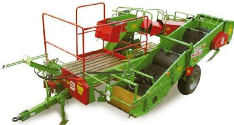
Картофелеуборочные комбайны однорядные Volko предназначены для уборки картофеля на полях с лёгкими и среднеплотными почвами, на которых уровень засоренности камней не превышает 5 т/га, при наклоне территории не больше 5°. В комбайне **Volko S** вместо бункера для картофеля, установлена
