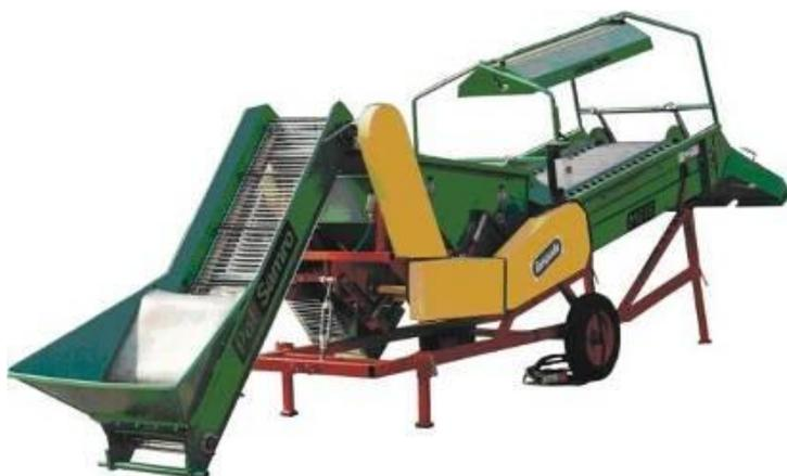
Сортировочный комплекс для картофеля М-616 предназначен для сортировки клубней картофеля и лука на 4 фракции:
