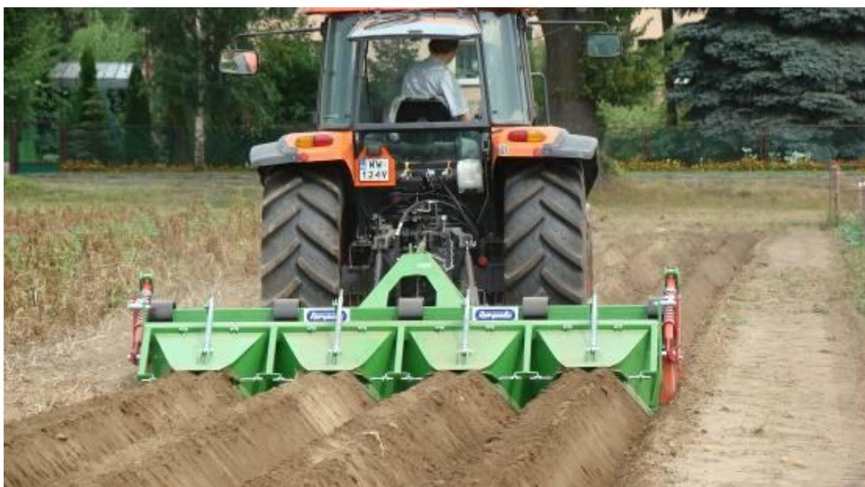
Гребнеобразователи UFO 97 и UFO 097/1, предназначены для обработки плантаций картофеля на средних и легких почвах. Машина характеризуется компактной и мощной конструкцией дающей возможность работы с большой скоростью при формировании рядков с оптимальной формой, что благополучно сказывается на урожае картофеля.
