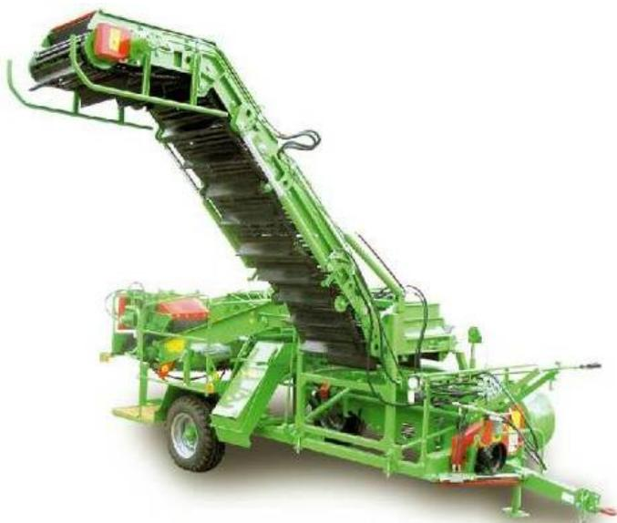
Картофелеуборочные комбайны однорядные Volko предназначены для уборки картофеля на полях с лёгкими и среднеплотными почвами, на которых уровень засоренности камней не превышает 5 т/га, при наклоне территории не больше 5°.
