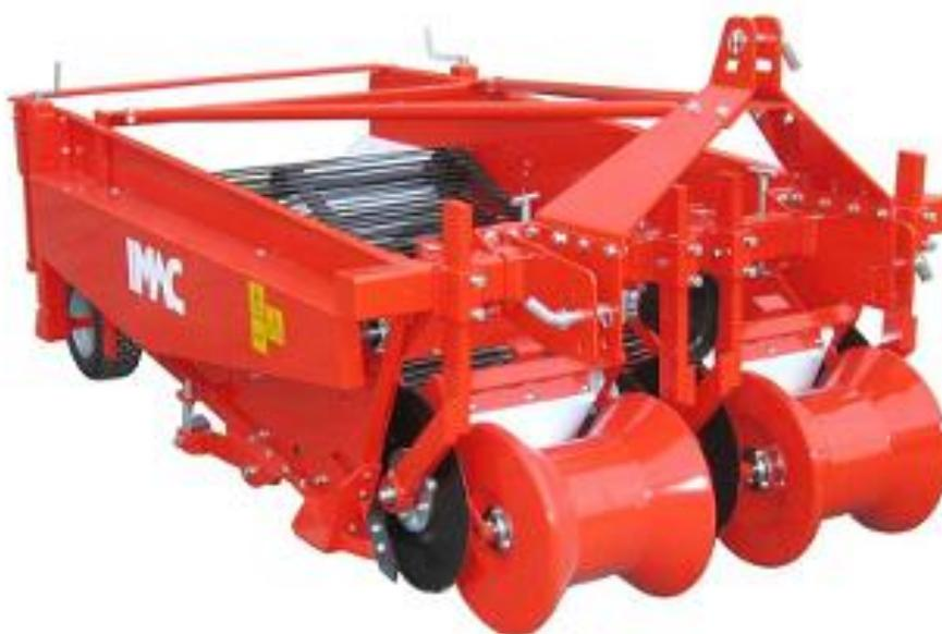
Предназначена для выкапывания и укладывания в валок картофеля, моркови, чеснока, лука и т.д.
