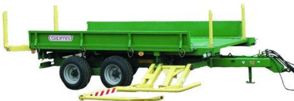
Тележка Т-150/1 является универсальным самозагружающимся прицепом грузоподъемностью 6,5 т. Загрузка тюков происходит автоматически путем подъезда под рулон боковым грейфером и подъема его с земли. Затем рулон при помощи толкателя передвигается в заднюю часть кузова, для загрузки очередных рулонов (до 8 шт.). В месте назначения разгрузка осуществляется путем наклона грузового отсека назад (вертикальное управление) или в бок (боковое управление).
