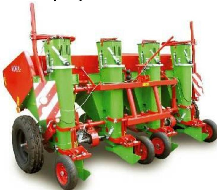
Четырёхрядная навесная картофелесажалка KORA 4 с ёмкостью бункера 840 (900 кг) предназначена для посадки не проросшего картофеля, высаживаемого в почвах влажностью до 16%, на полях с углом наклона до 7-12%. Отличительными особенностями, являются высокая точность посадки и возможность установки доп. оборудования. Ширина междурядий 75 - 90 см.
