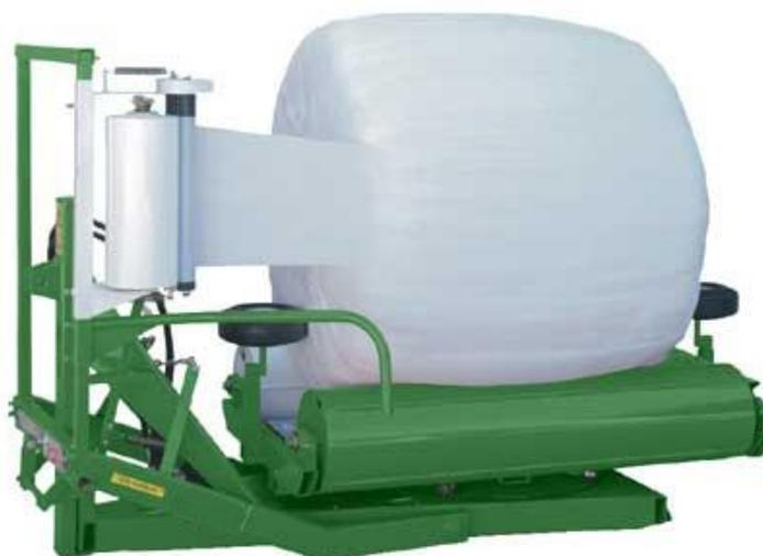
Навесные обмотчики Z-274 и Z-274/1 предназначены для малых и средних сельских хозяйств. Монтируются на задней трехточечной навеске трактора. Модель Z-274 создана для работы с пленкой шириной 50см, а модель Z-274/1 имеет универсальный подаватель, рассчитанный на две ширины пленки: 50см и 75см. Благодаря гидравлическому подъемнику трактора, обмотчик выгружает рулоны самостоятельно. Обмотчик имеет счетчик, который показывает текущее
