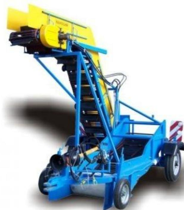
Предназначен для уборки с рядков выкопанного картофеля и погрузки на идущее рядом транспортное средство.
