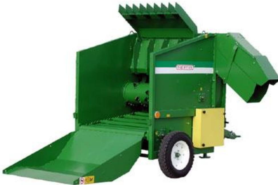
Предназначен для измельчения круглых рулонов соломы сена и зеленой массы с максимальным размером рулона 1,2x1,5м.
