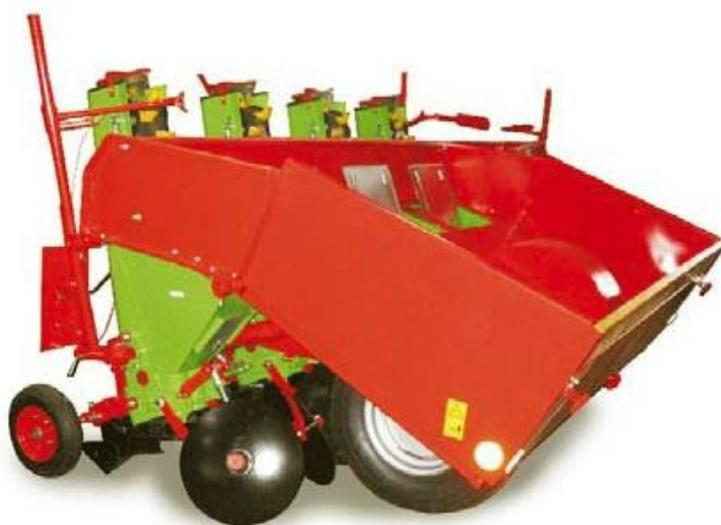
Четырёхрядная навесная картофелесажалка KORA 4H с гидравлически поднимаемым бункером ёмкостью 1100 (1150 кг.) предназначена для посадки не проросшего картофеля, высаживаемого в почвах влажностью до 16%, на полях с углом наклона до 7-12%. Отличительными особенностями, являются высокая точность посадки и возможность установки доп. оборудования. Ширина междурядий 75 - 90 см.
