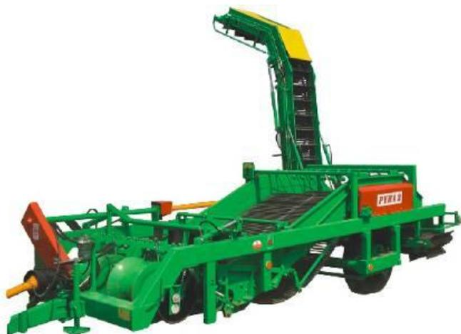
Картофелеуборочный комбайн двухрядный PYRA 2 применяется главным образом там, где необходимо быстро собрать картофель с поля. Производительность в зависимости от почв и ширины междурядий - до 0,45 га/ч. Комбайном можно работать на междурядьях шириной от 75 см до 90 см. Комбайн копает два ряда одновременно, а картофель выгружает на транспортное средство, едущее рядом. Высота
