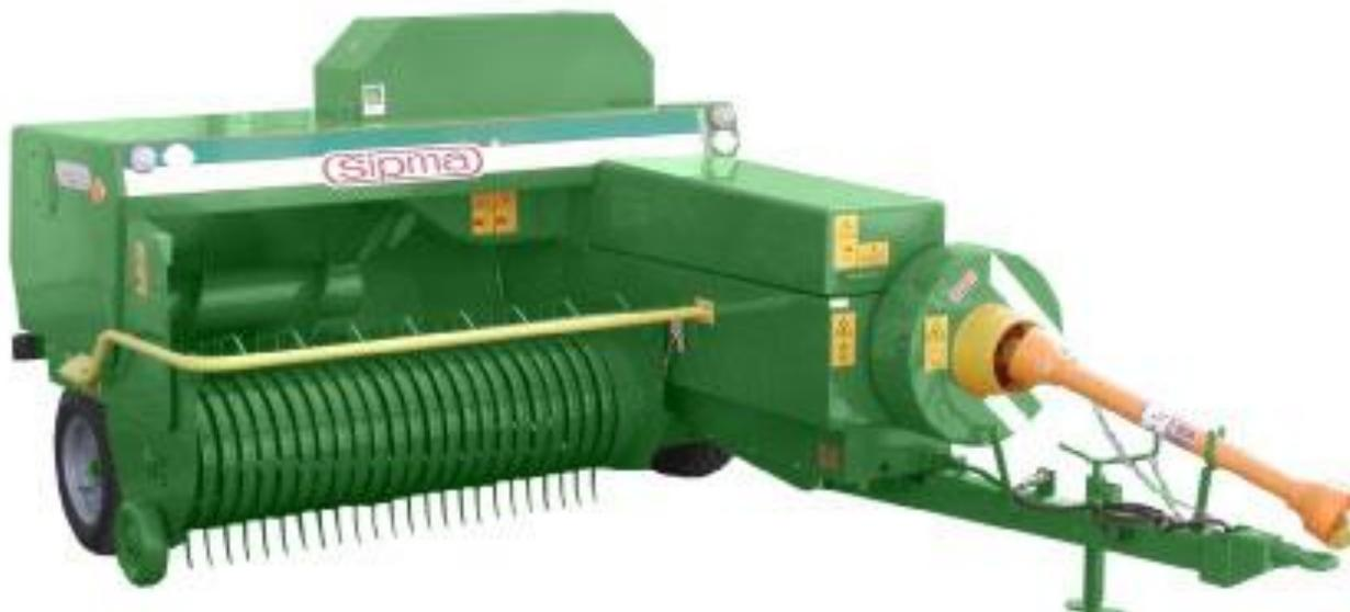
Пресс-подборщики высокой степени прессования Z -224/1 и Z-224/2 предназначены для сбора, прессовки и закатки в прямоугольные тюки сена с прокосов и соломы после уборки зерновым комбайном, а также сухих бобовых растений. Рулоны сена и соломы сбрасываются на поле или соскальзывают на прицеп. Пресс работает с тракторами мощностью от 38 л.с.
