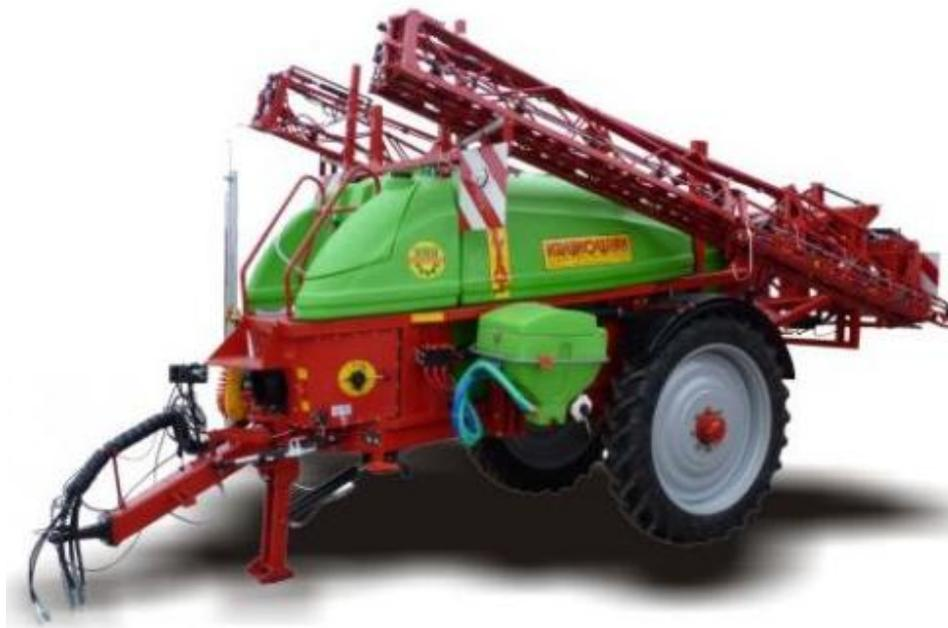
В опрыскивателях серии **PROFI GOLIAT** стандартно монтируются известные, благодаря высокому качеству и долговечности, насосы „COMET”, фильтры, корпуса распылителей, а также управляющие клапаны с компенсацией давления, выключение одной из секций, которых не несёт за собой увеличения давления в остальных, фирмы „ARAG” крупнейшего в мире производителя узлов для опрыскивателей, простые и эффективные в использовании смесители „Polmac”.
