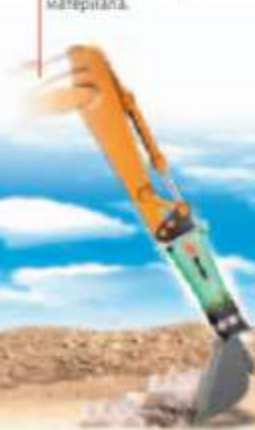
Гидромолот + сменный ковш Для удаления разрушенного материала.
